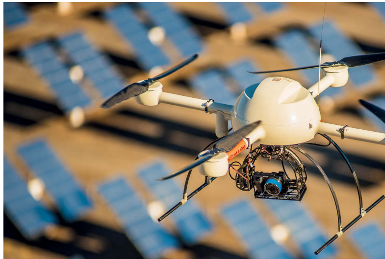
Abbildung 6 Flugdrohnen mit hochauflösender Digitalkamera beim Überflug über ein Solarfeld. Quelle: DLR
