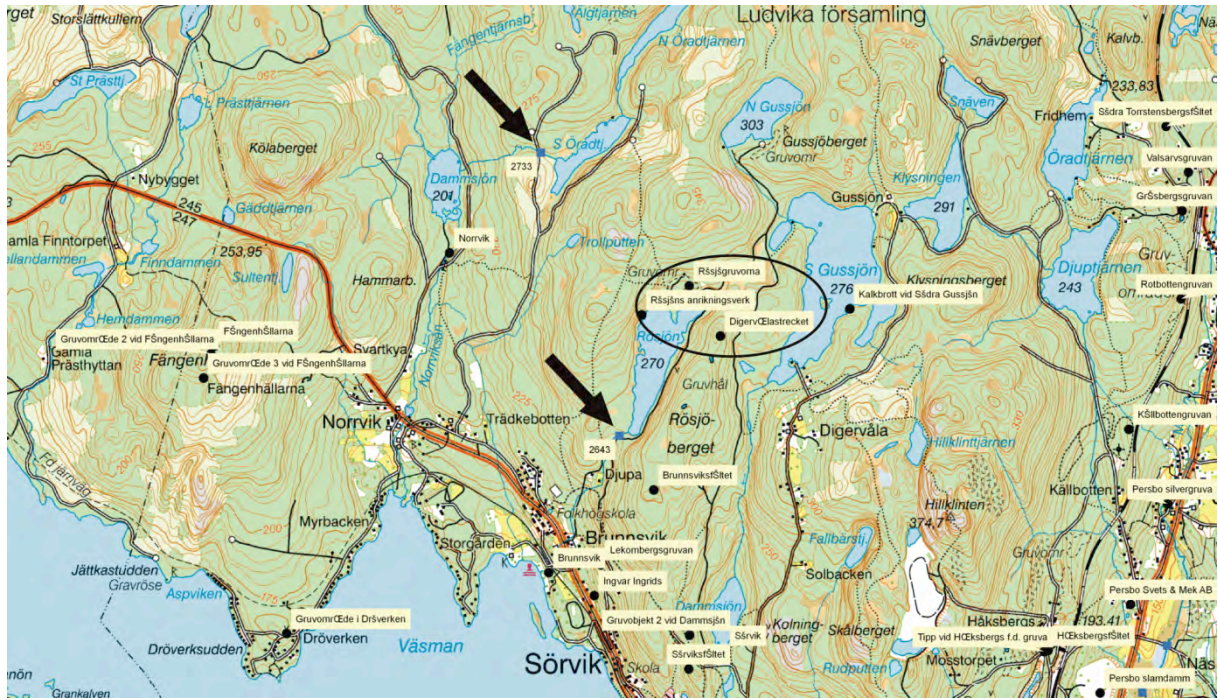
Figur 2: Sveriges topografiska karta i ArcGIS med skikt för provtagningspunkter (blå fyrkanter, markerade med svarta pilar) och MIFO-objekt (svarta cirklar). Provtagningspunkten 2733 ligger uppströms gruvobjekt ”Norrvik” och behålls i mätseriedatabasen. Provtagningspunkten 2643 ligger däremot nedströms flera gruvobjekt såsom ”Rösjögruvorna” och ”Rösjöns anrikningsverk” (inringade) och plockas därför bort ur mätseriedatabasen.
