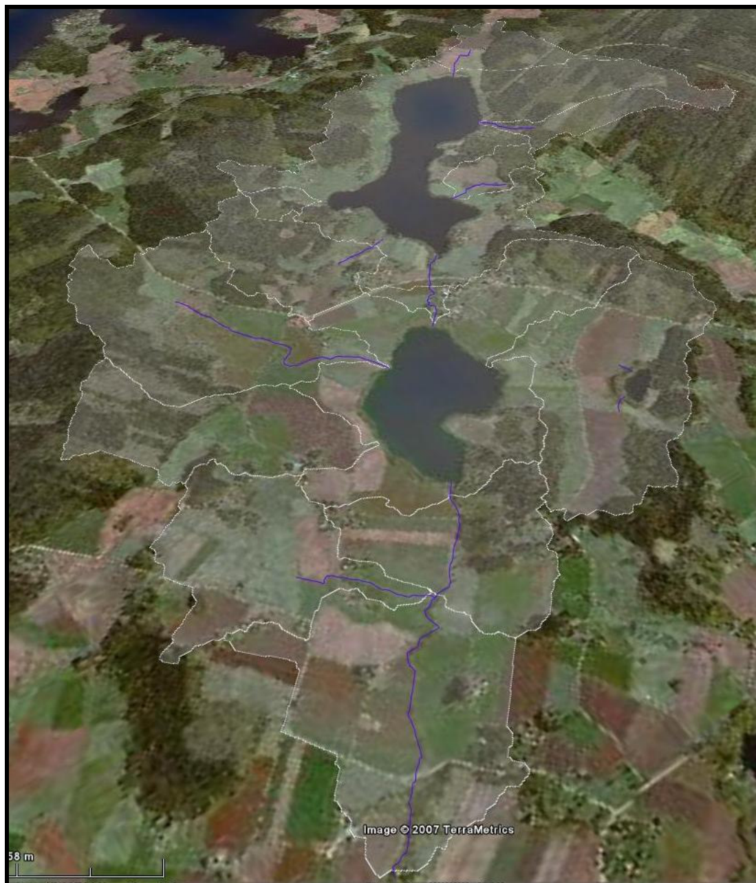
Figur 1. Avrinningsområdet med Övre och Nedre Milsbosjön indelat i delavrinningsområden och med utloppet till Dalälven.
