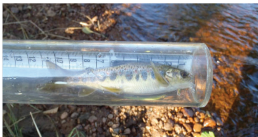
Figur 6.20. Mät rör i plast (Alenäsrör) för mätning av fisk utan att använda bedövningsmedel. Röret skall fuktas invändigt innan fisken förs in. Foto: Per Ingvarsson.
