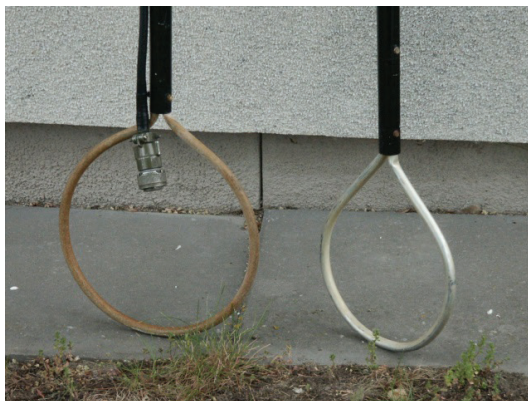
Figur 6.8. Elfiskestavens nedre del med den strömförande ringen (pluspol; anod). Konventionell elfiskestav av den typ som används till märket Lug AB. Anodringen till vänster på bilden är en standardring på 25–30 cm medan anodringen till höger är en mindre ring som i vissa fall används för att fånga årsungar av öring eller andra mindre fiskar.
