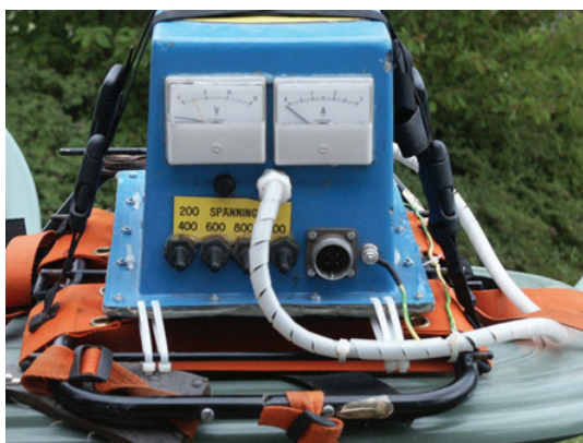
Figur 6.3. Strandbaserat elfiskeaggregat av märket Lug AB L-1000. Med vippströmbrytarna kan 200-1000 Volt ställas in (i steg om 200 V). Grön-gul sladd utgör minuspol (jordnät) och läggs ut i vattnet. Aggregatet sitter på en enkel bärmes för transport från bilen till lokalen, men inte för att bäras vid fisket! Aggregatet uppfyller inte EU:s krav på säkerhet och saknar CE-märkning.
