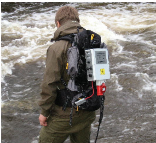
Figur 6.6. Batteriefiskeaggregat av märket Geomega FA 4. Aggregatet bärs på ryggen under elfiske och är därför försedd med en lutningsbrytare. Jordflätan (ej med på bilden) släpar efter elfiskaren i vattnet.
