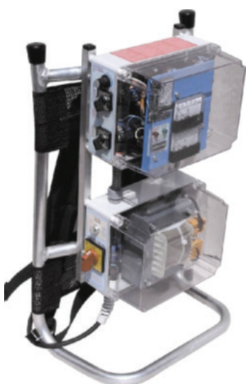
Figur 6.3. Strandbaserat elfiskeaggregat av märket Lug AB L-1000. Med vippströmbrytarna kan 200-1000 Volt ställas in (i steg om 200 V). Grön-gul sladd utgör minuspol (jordnät) och läggs ut i vattnet. Aggregatet sitter på en enkel bärmes för transport från bilen till lokalen, men inte för att bäras vid fisket! Aggregatet uppfyller inte EU:s krav på säkerhet och saknar CE-märkning.
