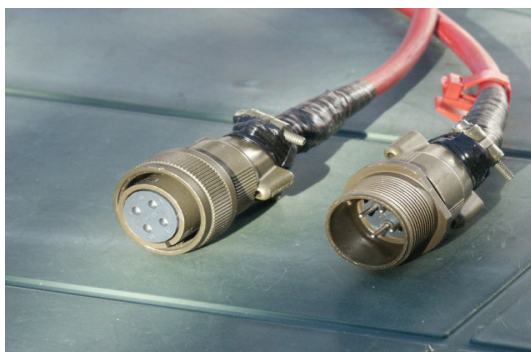
Figur 6.13. Hon- resp. hankontakt av IIT Cannon-typ med aluminiumhölje.
