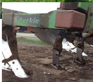
En av deltagarna konstruerade en djupluckrare som fungerade vid luckring i kombination med bäddläggning före stensträngläggning.
