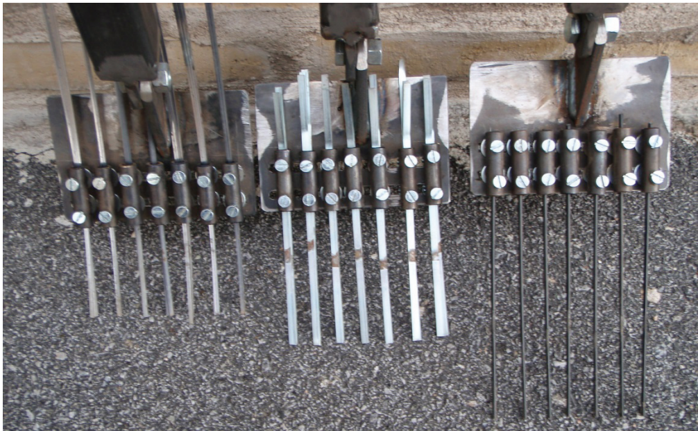
Bild 1. Tre harvaggregat med olika "harvpinnar" som undersöktes vid selektiv harvning i raden. De harvpinnar/borstknippen som undersöktes var: smala platta (tv), breda platta fjäderblad (i mitten) samt runda fjäderblad (th). Foto David Hansson.
