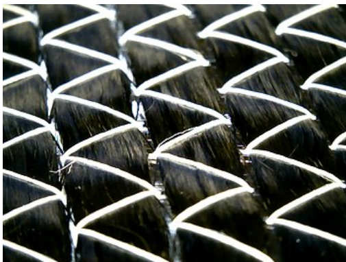
(a) Vorderseitenbindung eines MAG mit Trikot-Bindung [13]
