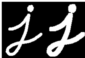
Abbildung 4.4.: Dilatation eines Objekts im Binärbild [35]
