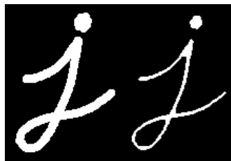
Abbildung 4.3.: Erosion eines Objekts im Binärbild [35]
