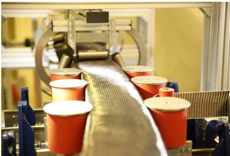
Abbildung 1.1.: Kontinuierliche Preformherstellung mittels GDU [8]
