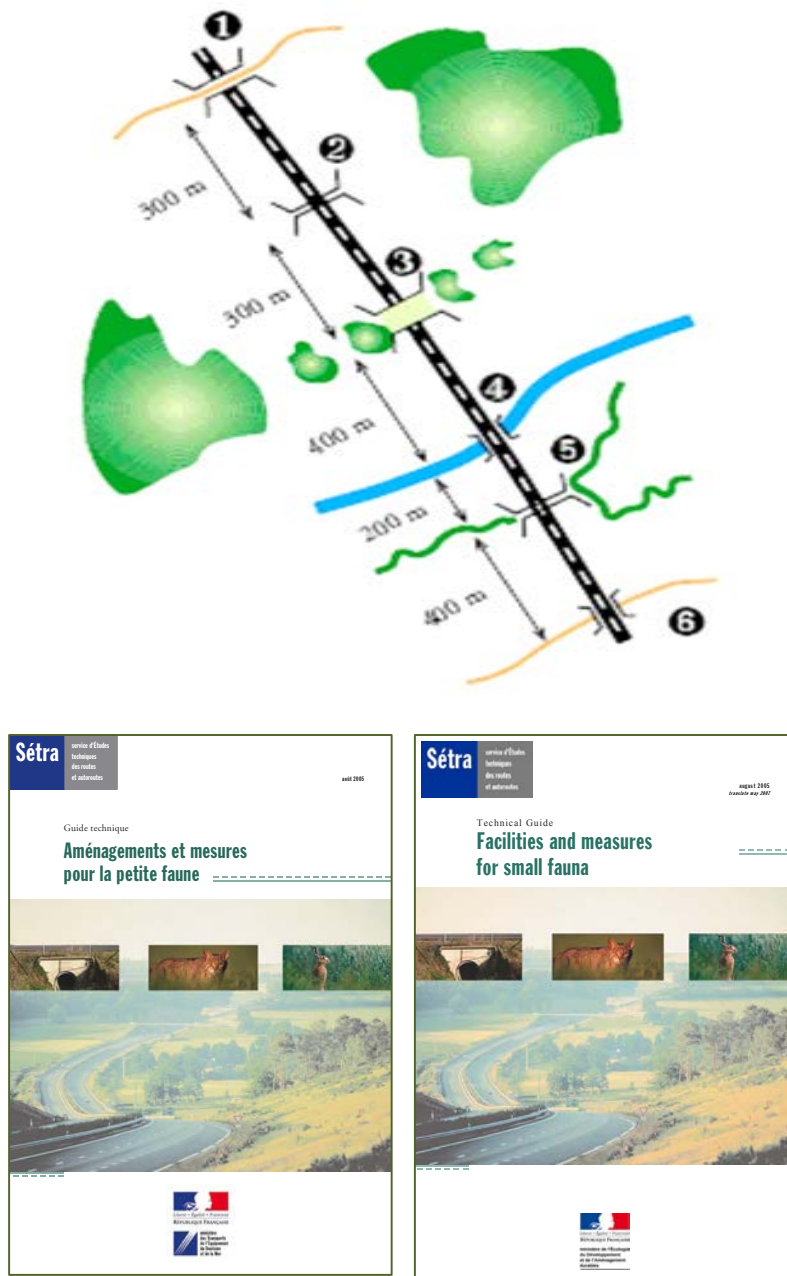
Figure 6.4 Illustration comparative de la distance recommandée qui sépare les ouvrages de franchissement aménagés en France et destinés à la faune de petite et de moyenne taille (300 m environ). Les numéros 1 à 6 font référence aux six types d'ouvrages routiers qui sont utilisés par la petite et moyenne faune (comme l'explique en détail le guide intitulé « Aménagements et mesures pour la petite faune » qui est signé par Carsignol et coll. 2005). (Source : Carsignol et coll. 2005, il est disponible en français (à la gauche) et en anglais (à la droite))
