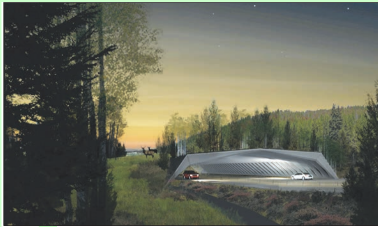
Figure C : La superposition de deux mondes : une structure sans piliers de même qu'un concept modulaire qui intègre un passage faunique supérieur, une construction qui utilise du béton préfabriqué (Source : HNTB et MVVA, 2010)
