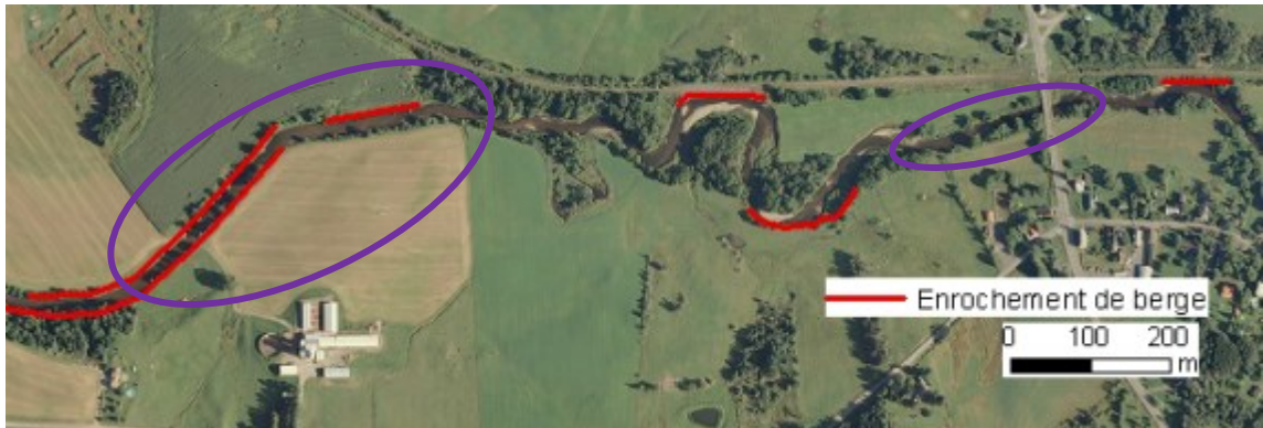
Figure 7-4 – Interventions anthropiques visibles au tronçon 5.
