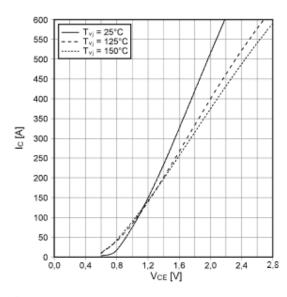
Ausgangskennlinienfeld IGBT-Wechselr. (typisch) output characteristic IGBT-inverter (typical)  $I_C = f$  (VcE)  $T_{vj} = 150^{\circ}C$
