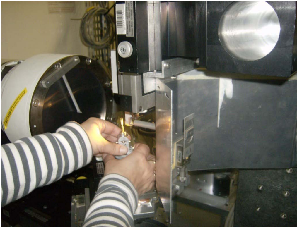
Fig.2.3. Colocación de la muestra del experimento realizado en la línea ID18F del ESRF.
