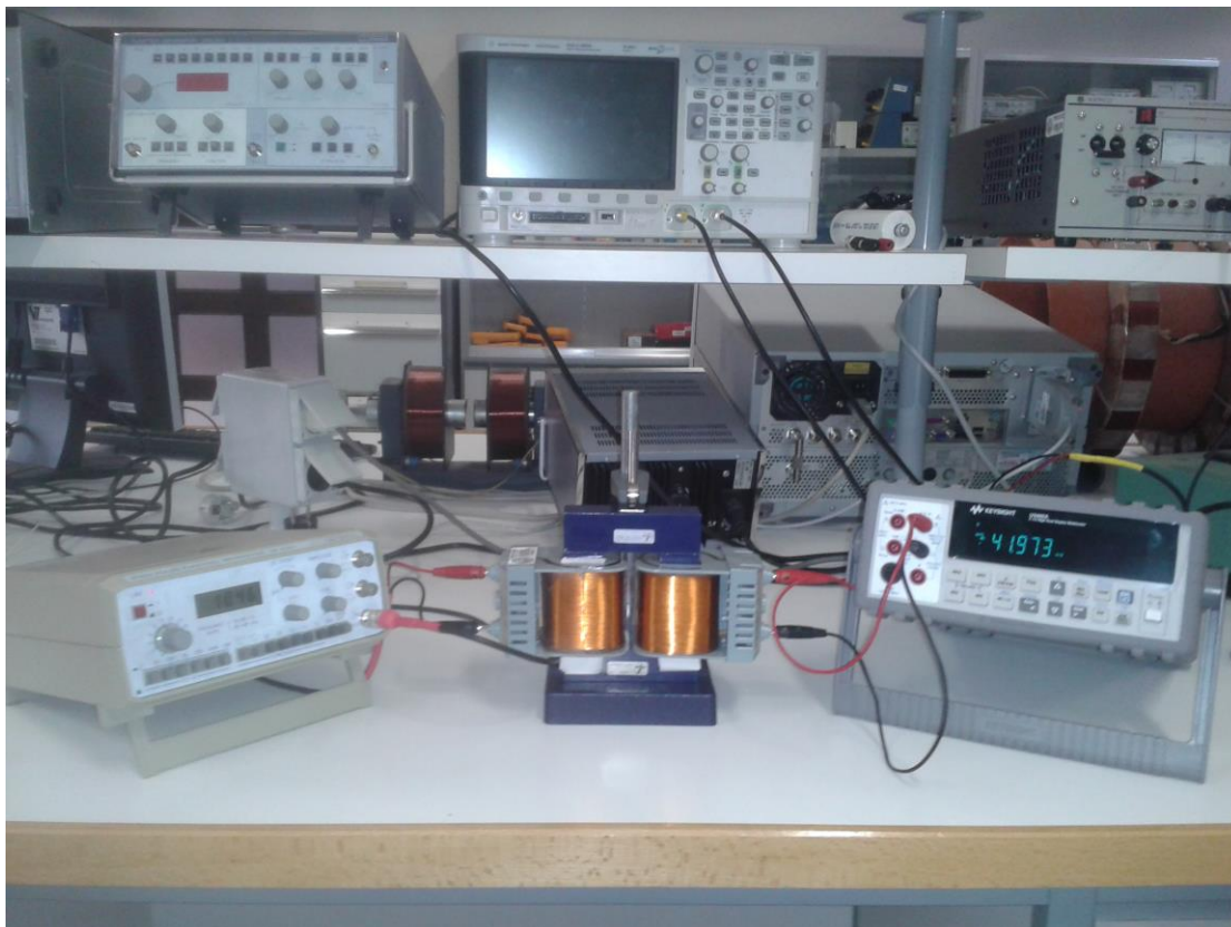
Montaje para el estudio de un transformado con núcleo de hierro laminado
