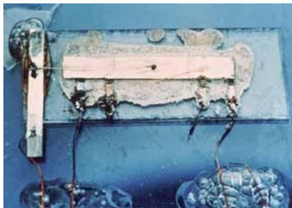
Figura I.3. Primer circuito integrado fabricado por Kilby en 1958. Consistía en un oscilador simple con cinco componentes integrados (fuente: Texas Instruments).
