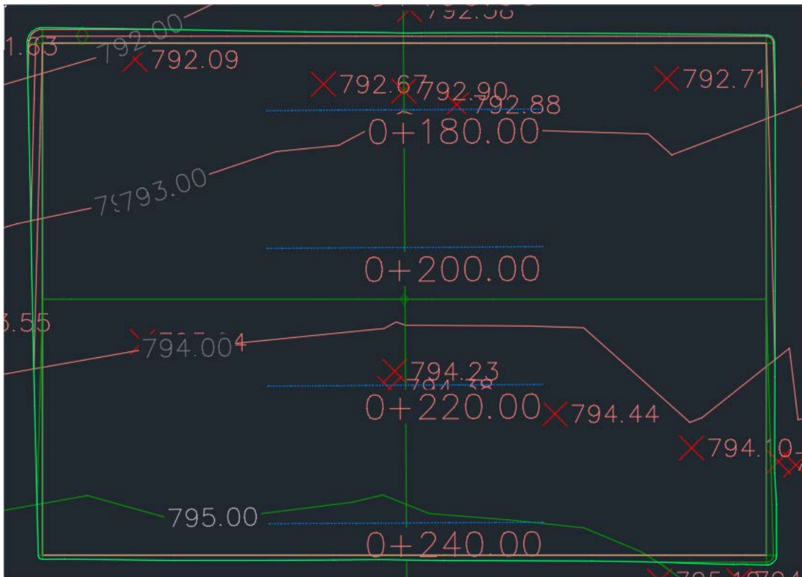
Figura 31. Tapar la plataforma tras el cálculo de la explanación.
