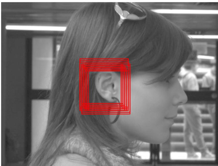
**Figura 3.2.6:** Muestra de múltiples detecciones superpuestas moldeadas como ventanas individuales de detección en una imagen de entrada
