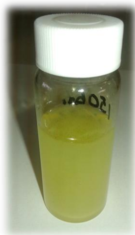
Figura 3.21.- Muestra líquida recogida en la GASC del fenol a 700 °C.
