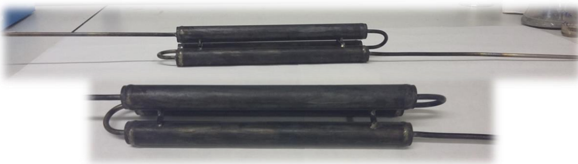
Figura 2.15.- Reactor utilizado en la degradación y gasificación del fenol.
