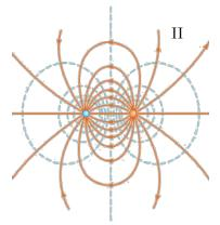
De esta forma, la solución para el potencial en la zona II (x > 0) es la superposición del potencial creado por dos cargas puntuales: La carga q situada a una distancia d del plano y la carga imagen -q situada a una distancia -d:
