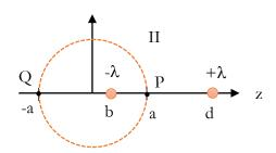
La esfera conductora puede estar conectada a cualquier potencial o puede estar aislada y tener la carga que sea. En cualquier caso, por ser conductora su potencial debe ser constante, y por ese motivo
