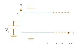
y = 0 y en y = a. En x = 0 cerramos las placas con otro plano conductor a potencial  $V_0$ , según se ve en la figura.
