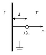
La técnica de las imágenes no sólo es válida para cargas puntuales. Imaginemos una línea infinita cargada uniformemente situada frente a un plano conductor infinito conectado a tierra. Debido a la similitud con el problema de una carga puntual, la carga imagen podemos adivinar que es otra línea de densidad –  $\lambda$  situada en -d.
