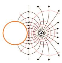
– II: Fuera de la esfera  $(r \ge a)$ . En esta zona, el potencial no sólo es el creado por la carga q, sino también el creado por la carga inducida sobre la superficie del conductor. Analizando las líneas de fuerza, la experiencia que tenemos sugiere simular el efecto de la esfera por una carga imagen puntual q', situada a una distancia b del origen. Como las líneas de fuerza terminan en la esfera conductora, la carga q' ha de ser negativa.
