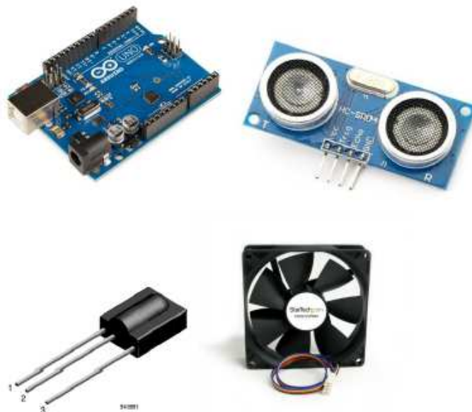
Figura 2. Proyecto de tacómetro: elementos utilizados (fotografía de los alumnos Alberto Iglesias, Jonathan Izquierdo y Carlos Zorita)
