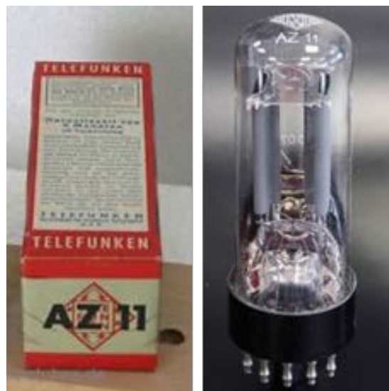
Fig.2. Envoltorio original del AZ11 y aspecto del AZ11
