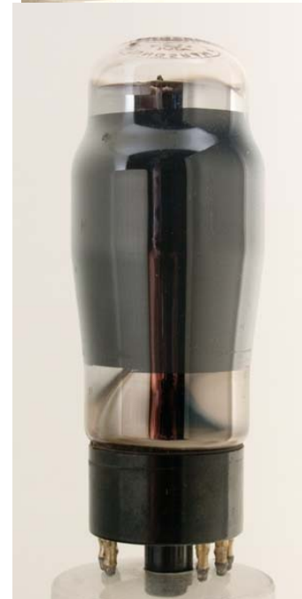
Fig.2. Aspecto exterior del EL11
