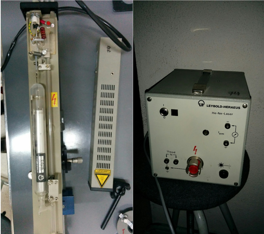
Figura 1. Láser de helio-neón (izquierda) y fuente de alimentación (derecha)
