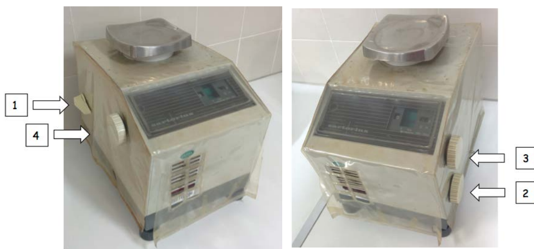
Fig. 2.-Detalle de los mandos de la balanzagranatariaSartorius.
