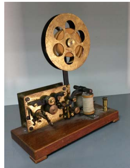
Fig.4. Receptor MORSE de la USAL
