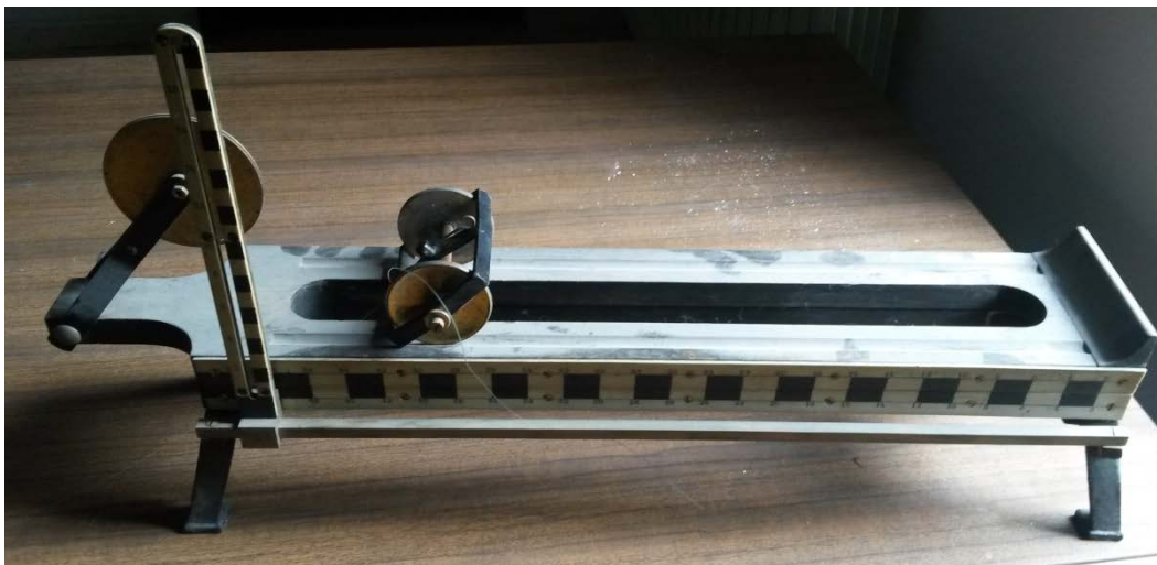
Fig. 3. El plano inclinado didáctico que se conserva similar al del catálogo de Max Kohl (Nº1862 Max Kohl p.267). La base se encuentra en buen estado pero no se conservan los pesos del carrito ni de la polea. Un plano inclinado similar se conserva en 4.
