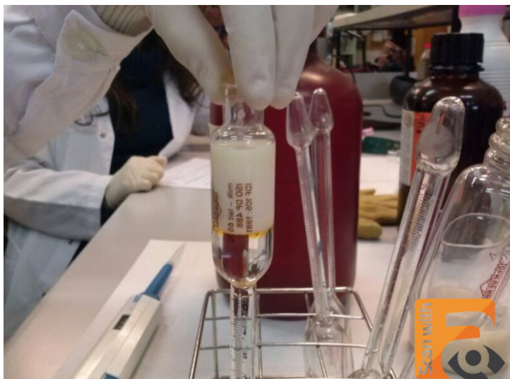
Ilustración 13. Butirómetro. VSearch Aumentaty
