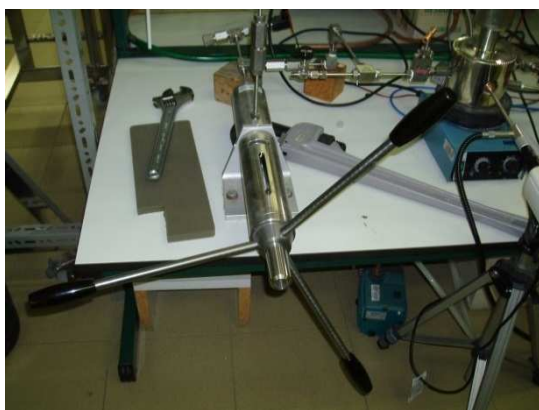
Figura 3.6. Celda abierta (a); celda cerrada con pistón (b); generador manual de presión (c); cámara (d)
