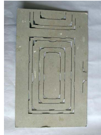
Figura 31b. Plantilla de cartón lista para el marcado.
