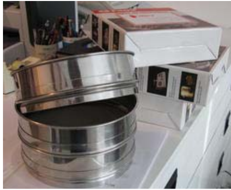
Figura 7. Tamices UNE 7050 para el ensayo.
