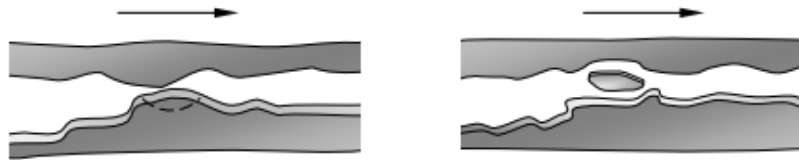
Fig. 26. Desgaste por fatiga entre dos superficies en deslizamiento [65].
