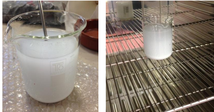
Fig. 59. Disolución de almidón/agua destilada (izq.); disolución dentro del horno (dcha.).
