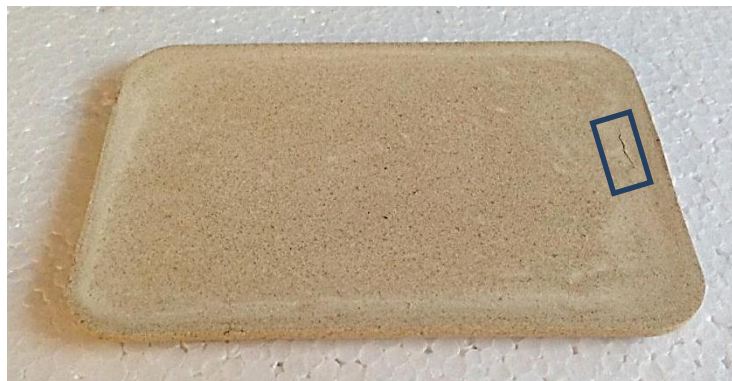
Fig. 74. Placa con grieta superficial después de su sinterizado.
