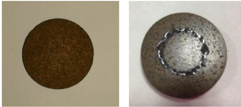
Fig. 103. Muestra 1250-PV50FL50: aspecto de la muestra (izq.) y pista de desgaste (dcha.).
