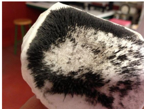
Fig. 33. Partículas ferromagnéticas retiradas del flux.
