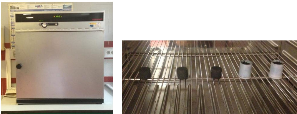
Fig. 41. Horno de secado y detalle de la operación.
