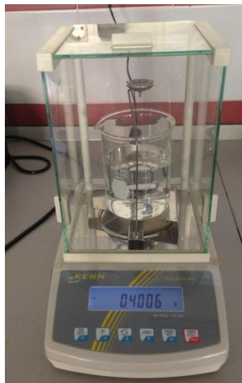
Fig. 44. Balanza de precisión con el utillaje necesario para realizar método de inmersión.
