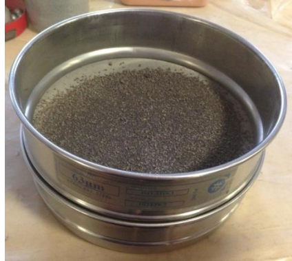
Fig. 32. Operación de tamizado para el flux.
