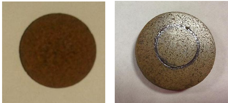
Fig. 99. Muestra 1300-PV60FL40: aspecto inicial de la pieza (izq.) y pista de desgaste (dcha.).
