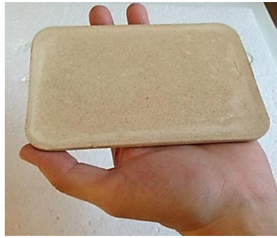
Fig. 75. Placa obtenida tras la sinterización. Se observa que es perfectamente manipulable.
