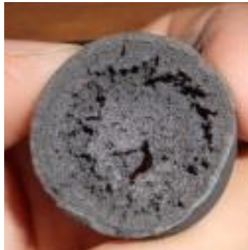
Fig. 62. Probeta con fenómeno de rechupe [22].
