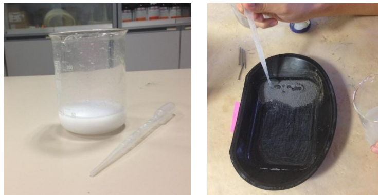
Fig. 39. Disolución de almidón de arroz y agua destilada (izq.); operación de vertido del ligante en la mezcla de polvos (dcha.).
