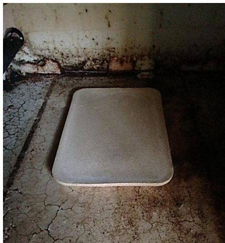
Fig. 73. Placa dentro del horno tras su sinterización.
