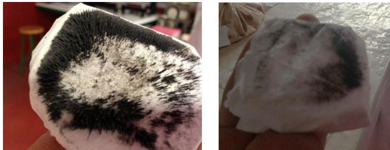
Fig. 64. Partículas férricas separadas en el primer tamizado (izq.) y el segundo (dcha.).
