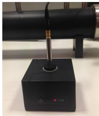
Fig. 50. Operación de calibración de los micrófonos.
