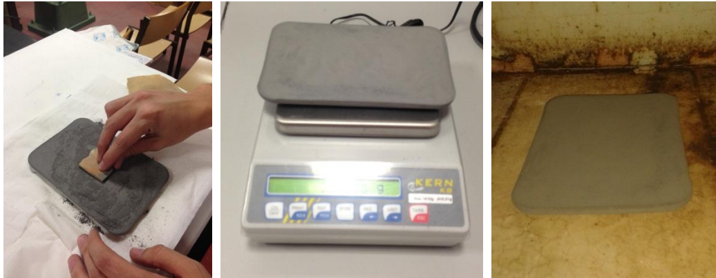
Fig. 61. Lijado de la pieza en verde (izq.), pesado (centro) y colocación en el horno (dcha.).
