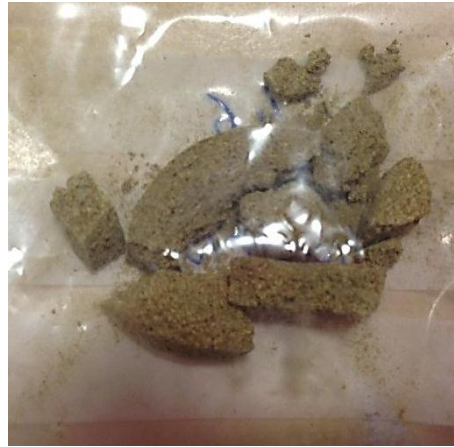
Fig. 107. Ensayo tribológico para la muestra 1250-PV60FL40 (izq.); restos de la pieza (dcha.).
