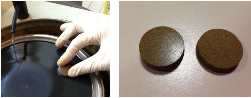
Fig. 52. Pulidora (izq.); comparación de pieza pulida y pieza sin pulir (dcha.).
