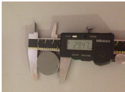
Fig. 43. Operación de medida tras el proceso de secado, donde se observa una ligera contracción con respecto a los 30 mm de diámetro.
