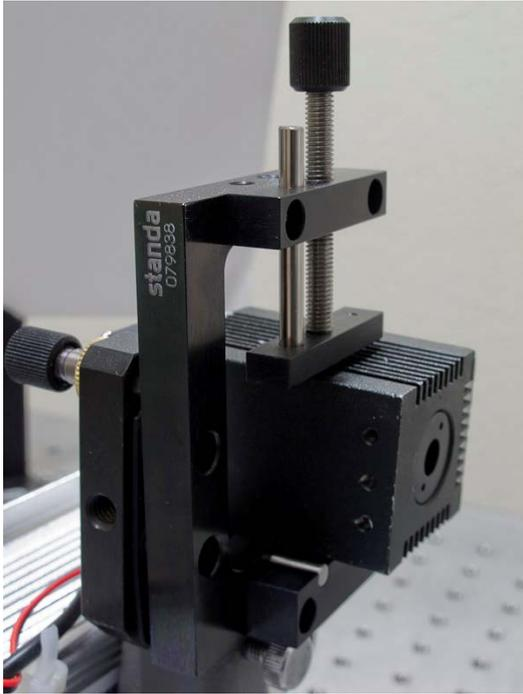
Detalle de las monturas, que permiten inclinación vertical y horizontal mediante tornillos de paso fino.
