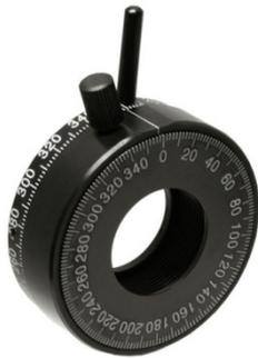
Soporte para láminas polarizadoras y retardadoras con escala graduada y precisión de 1º
