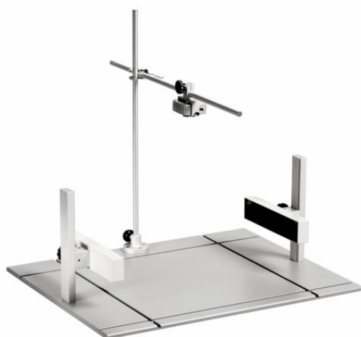
Imagen 14. Núcleo ANY-box core . En la imagen podemos observar la plataforma y la varilla ajustable con la cámara. A ambos lados de la plataforma se pueden ver los sensores de luz infrarroja.
