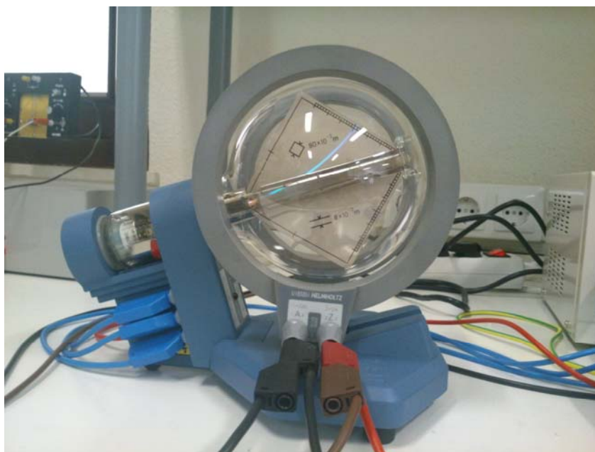
Figura 3: Vista del haz de electrones curvado por efecto del campo magnético
