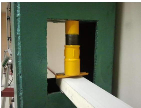
Figura 11.- Imagen de los apoyos de la probeta en ambos extremos de la bancada
