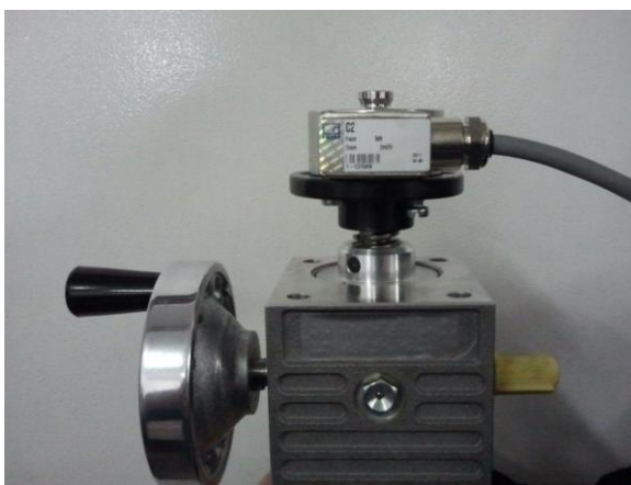
Figura 3.- Vista lateral del actuador con la célula de carga montada en la parte superior
