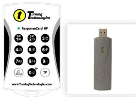
Figura 1. Emisor y Receptor de radiofrecuencia
