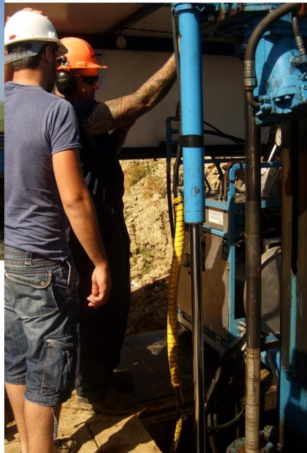
**Figuras 7a y 7b:** Máquina de sondeo a rotación con recuperación de testigo trabajando en la Faja Pirítica Portuguesa.
