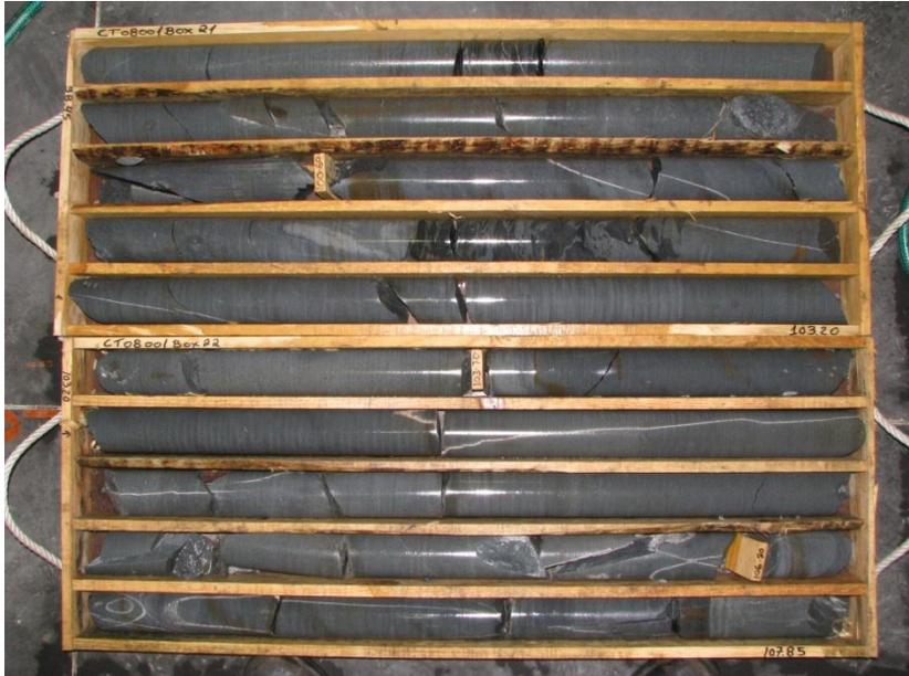
**Figura 9:** Ejemplo del flysch, de 98 a 108 m de profundidad
