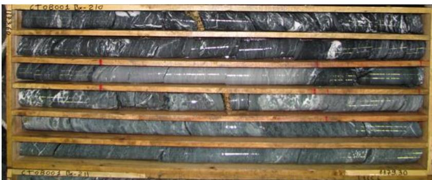
**Figura 14:** Jaspe brechificado con chert, de 1076.56 a 1177.39 m de profundidad. A partir de 1177.39m se observan las riolitas cloritizadas.
