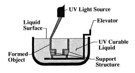
Figure 1: Stereolithography Apparatus (SLA)
