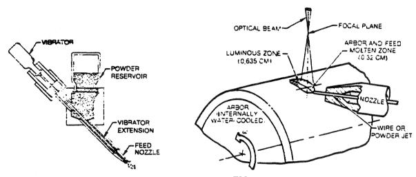
Figure 8: LAYERGLAZE<sup>TM</sup> Powder Method
