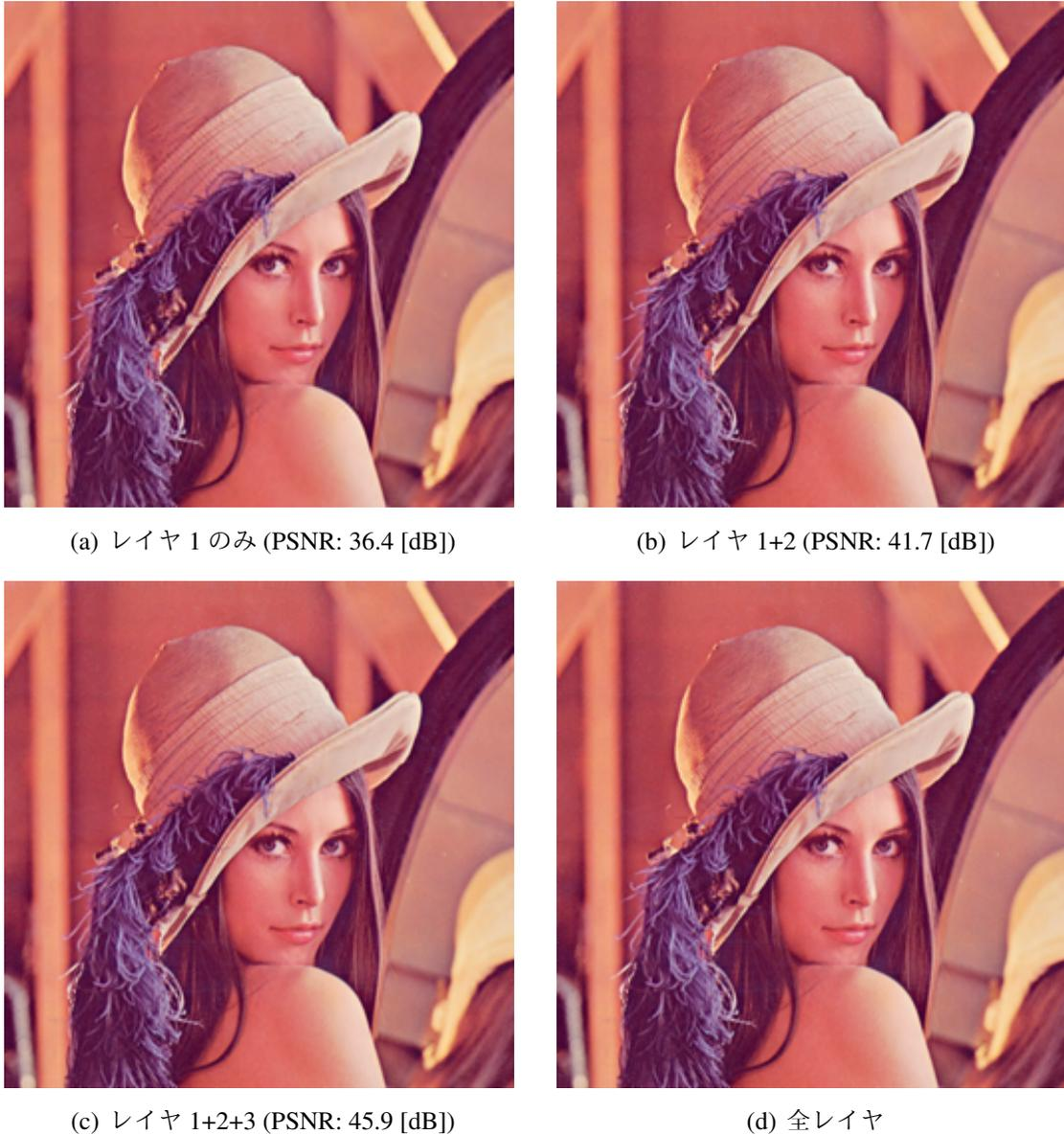
図 3.8: JPEG 2000 により符号化したコードストリームの段階的な復号結果
