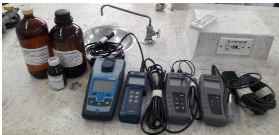
Figura 2: Equipos utilizados para la caracterización de agua lluvia
