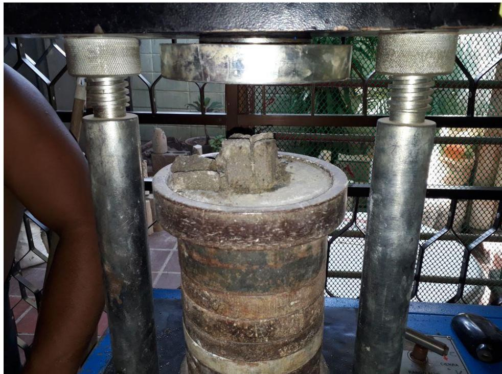
Figura 15: Especimen de mortero después de fallado Fuente: Morales L.
