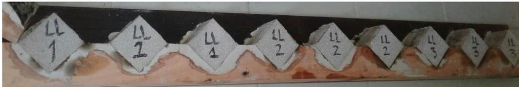
Figura 9: Desencofrado de especímenes, 24 horas después de elaborados
