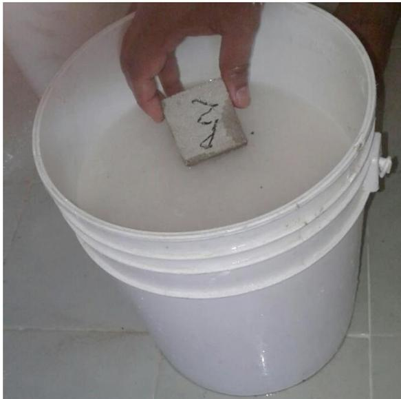
Figura 12: Especímenes sumergidos en agua con cal.
