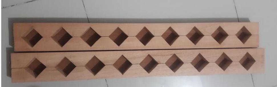
Figura 3: Moldes utilizados para la realización de los especímenes antes de impermeabilizar. *Fuente: Elaboración propia Morales L.*
