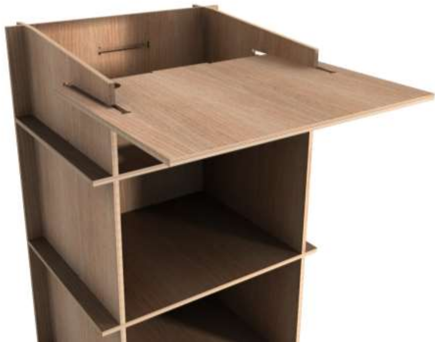
Figura 3.2.21 Detalle montaje de una balda. Imagen propia.
