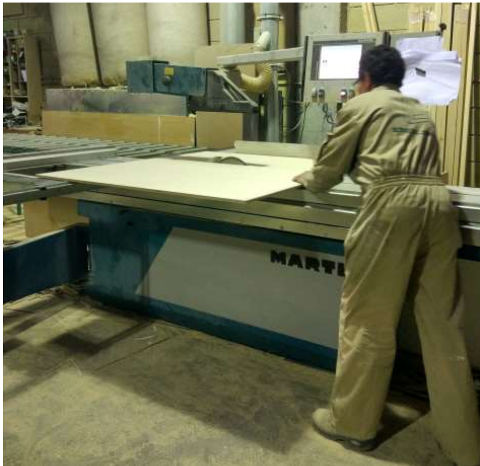
Figura 5.3.1 Corte de las dimensiones generales de las piezas. Imagen propia.
