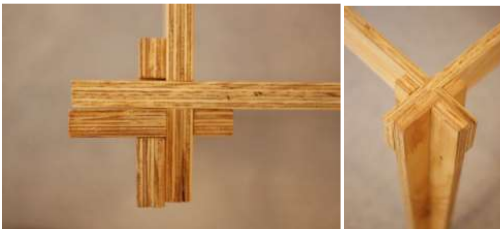
Figura 2.44.1 Cruces en el ensamblaje de la mesa CROSS. Imagen propia.
