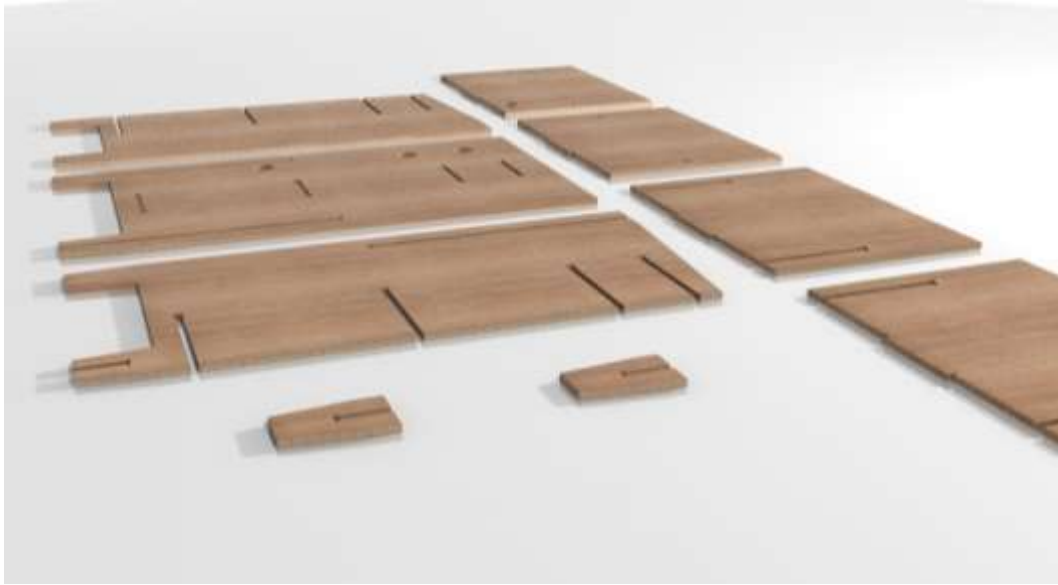
Figura 3.2.3 Despiece del mueble para tocadiscos CROSS III. Imagen propia.
