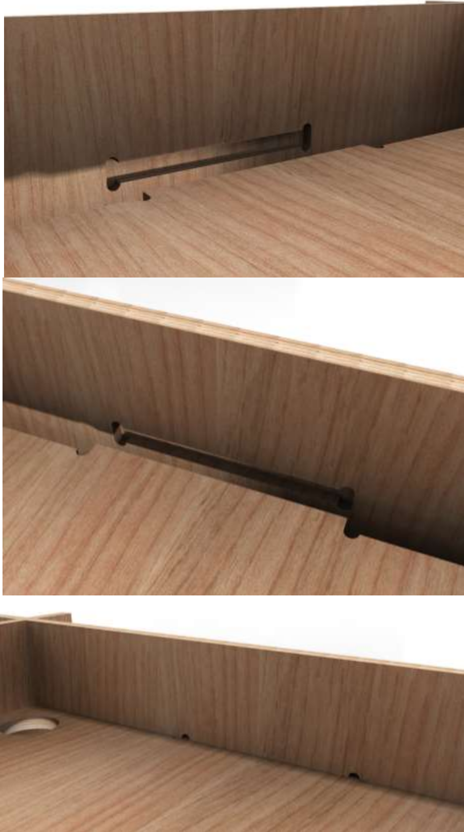
Figura 3.2.22 Detalle de montaje de una balda II. Imagen propia.
