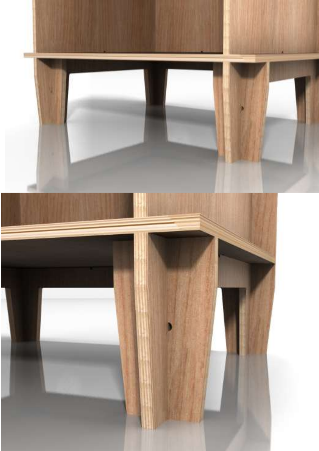
Figura 3.2.10 Detalle cruces de las patas. Imagen propia.
