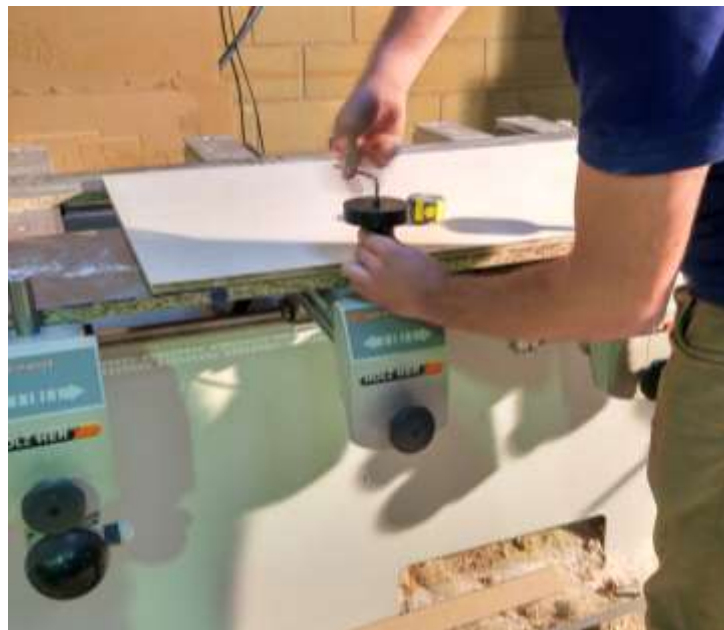
Figura 5.3.3 Sujeción de piezas a la máquina. Imagen propia.
