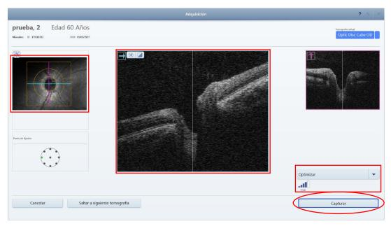
Figura 19.- Pantalla de captura de imagen "ONH & RNFL" centrada y optimizada (OCT Primus 200, Zeiss)
