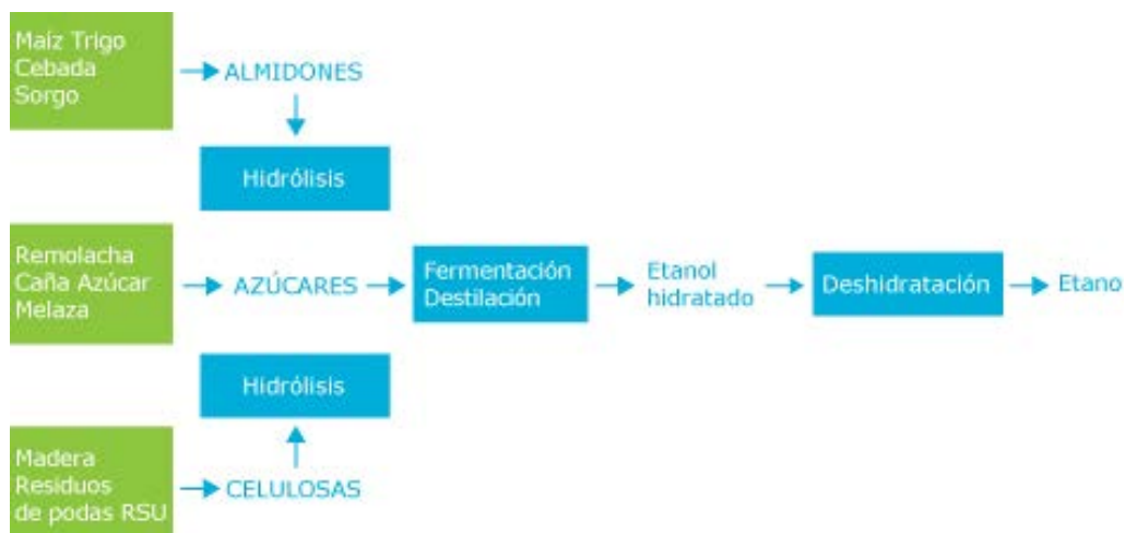
FIGURA 1. FORMACIÓN DEL ETANOL. ( HTTP://WWW.ALCONOA.COM.AR/PROCESO.HTML )
