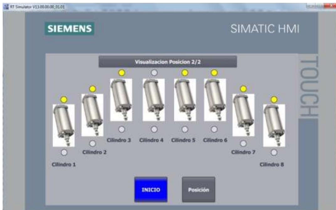
Figura 4.46 HMI falta presencia retroceso cilindro 4 – Posición
