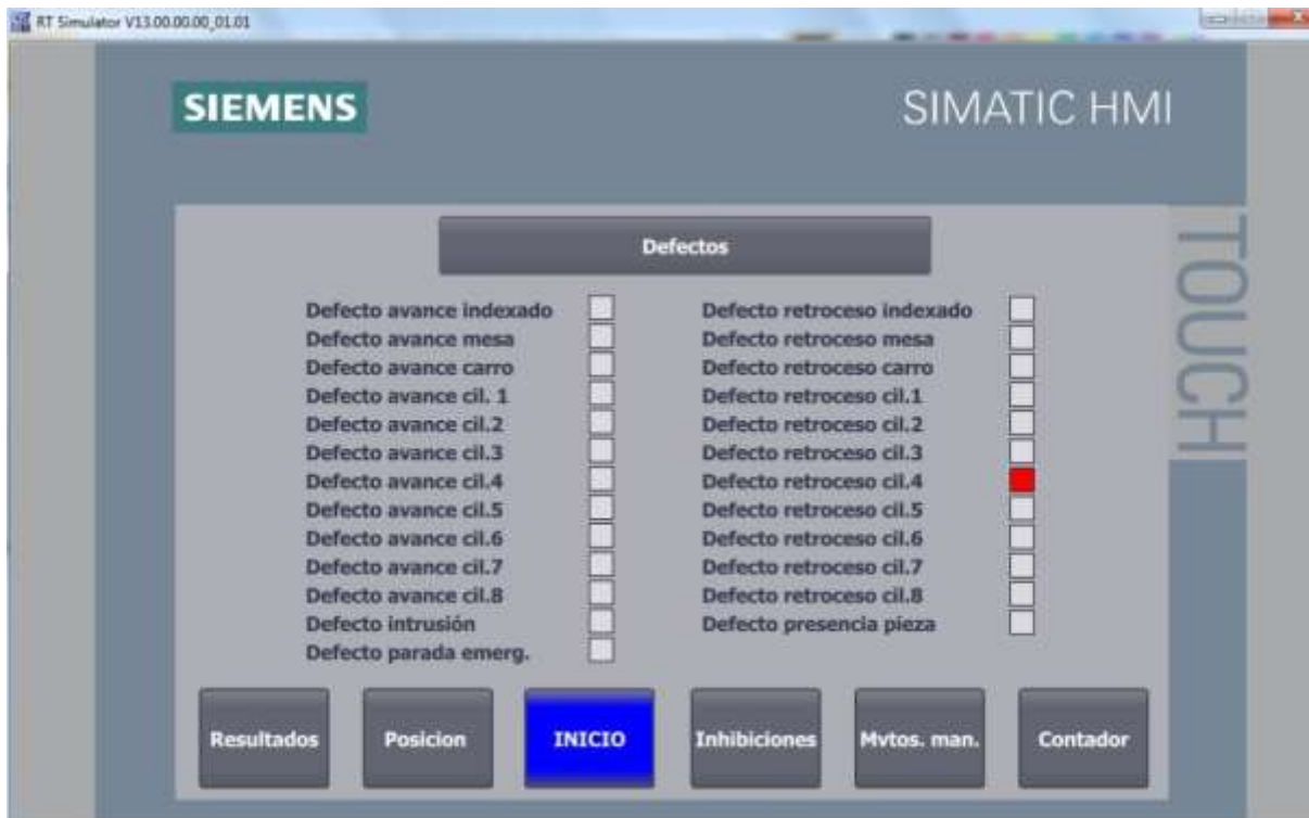
Figura 4.45 HMI defecto retroceso cilindro 4
