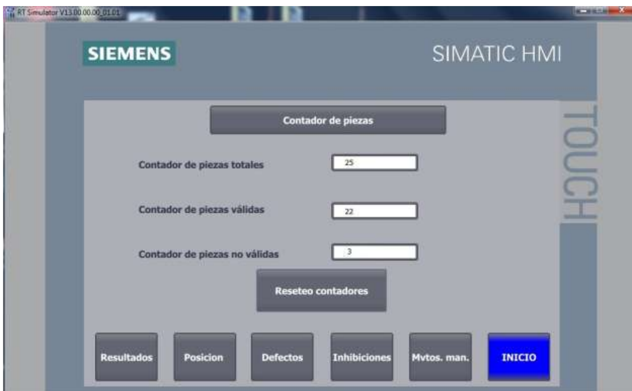
Figura 4.43 HMI pantalla contadores
