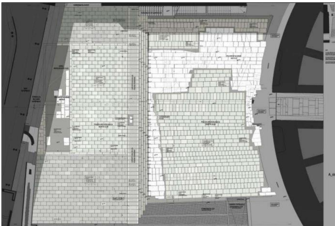
Img. 37. Planta de la pavimentación de la Plaza donde vemos en un color más claro el adoquinado encontrado del siglo I, y en un tono más oscuro la pavimentación nueva que se propone en el proyecto, la cual es del mismo material pero con otro tratamiento para que se haga ver la diferencia entre ellas. También vemos en esta imagen las dos cotas de la Plaza, separadas por unas escaleras. La más baja es la que da acceso al Mausoleo y la más alta es la correspondiente con el nivel de la cafetería.
