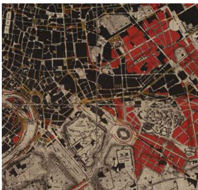
Img. 11. Plan Regulador de 1873. En amarillo "demoliciones" y en rojo "nuevas edificaciones".
