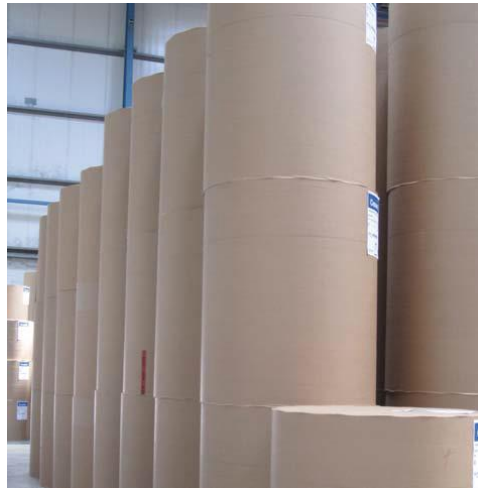
Figura V.1.4: Almacenamiento de bobinas sin paletizar sobre el suelo
