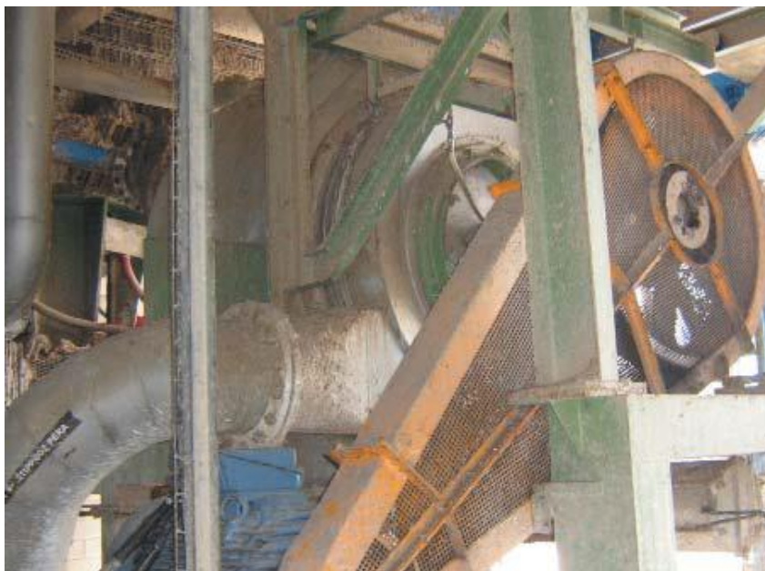
Figura V.3.6: Resguardo fijo en transmisión de correas. Se debe crear una envolvente en torno a la zona peligrosa, de forma que sea inaccesible
