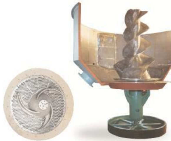
Figura I.3.9: Hélice para púlper de alta consistencia, y a la izquierda hélice para baja consistencia.
