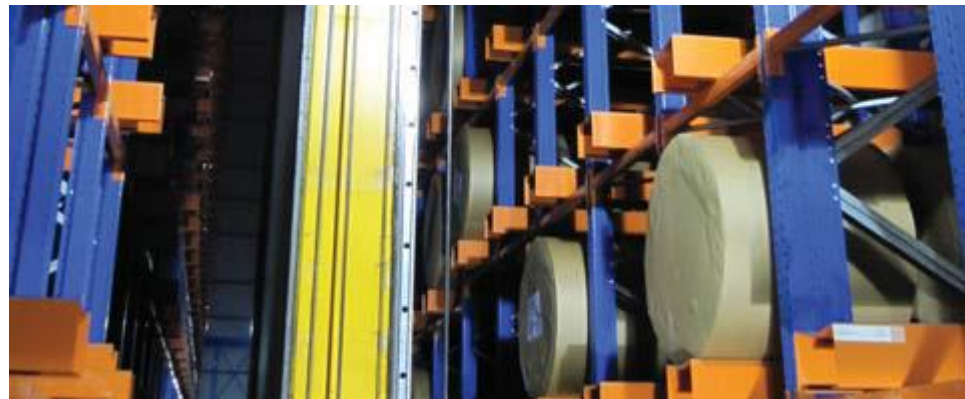
Figura V.1.9: Sistema automático de almacenamiento de bobinas en horizontal
