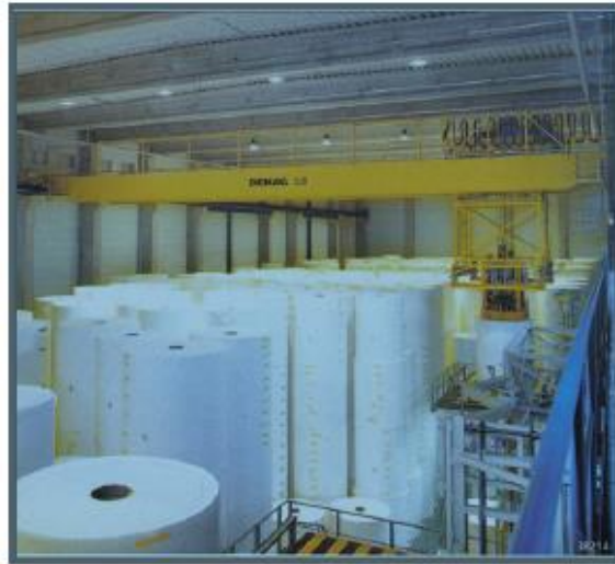
Figura V.1.8: Sistema automático de almacenamiento de bobinas en vertical.
