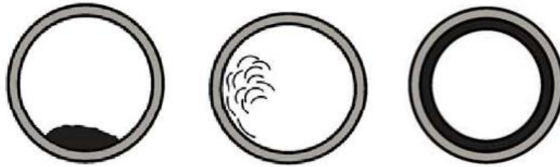
Figura I.3.60: Distintos regímenes que se pueden dar en los condensados en función de la velocidad de la máquina
