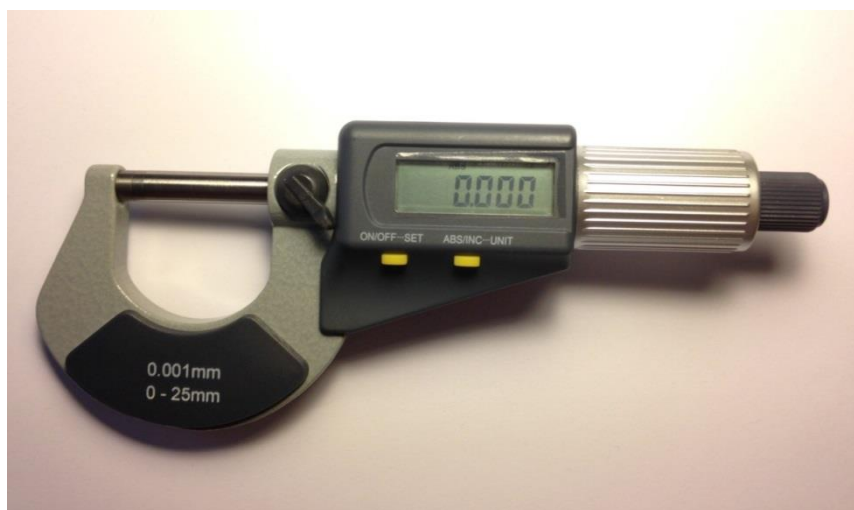
Imagen 2.3: Micrómetro utilizado de 0 a 25 mm.
