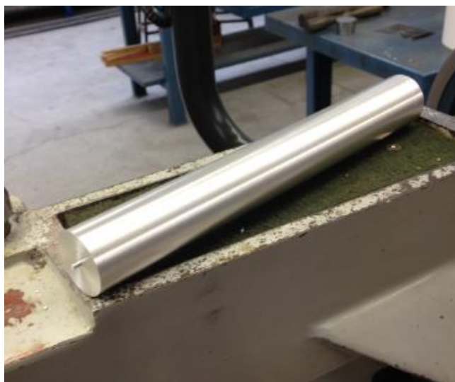
Imagen 4.2: pieza cilindrada y tronzada a 300 mm.
