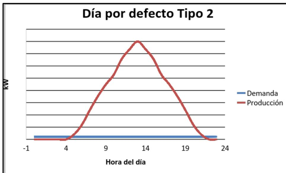
Figura 28 – Demanda y producción de energía en un día por defecto en la instalación fotovoltaica de tipo 2.
