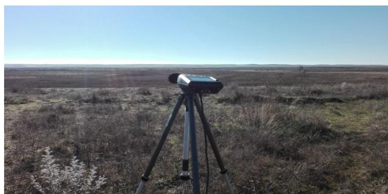
Ilustración 4.4. Sonómetro realizando la medición
