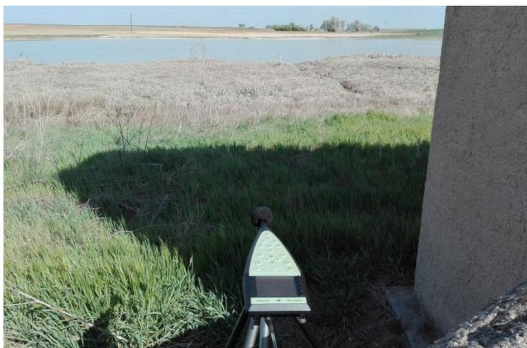
*Ilustración 4.25. Posición del sonómetro, lo más resguardado posible del viento*
