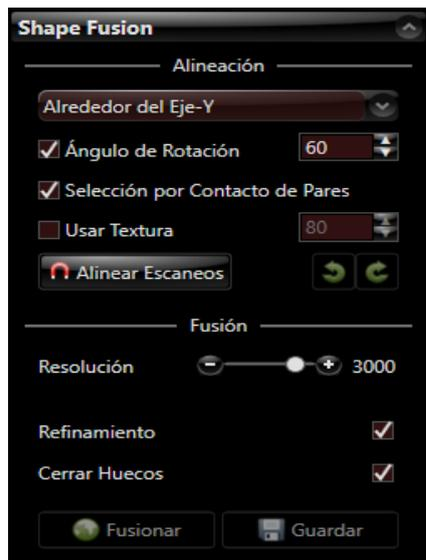
Figura 3. 24 Configuración del Shape Fusion.
