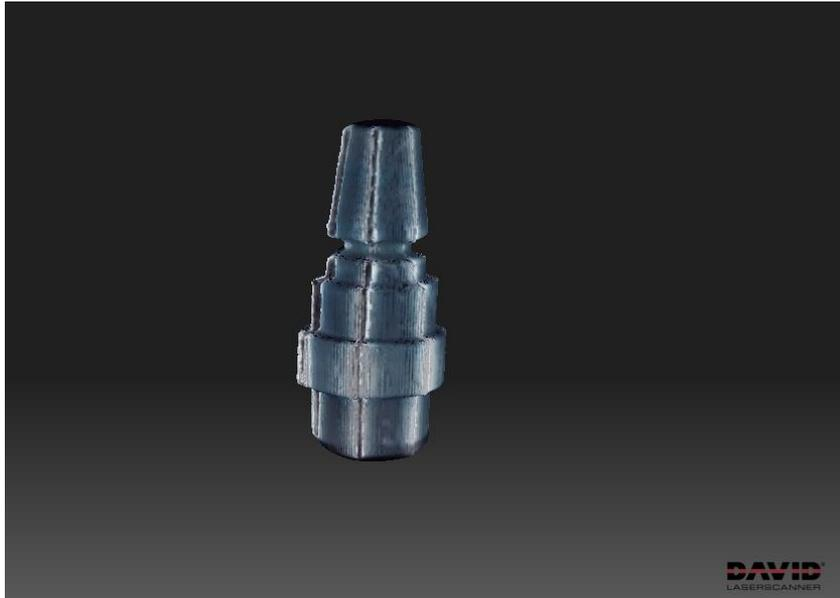
Figura 5. 8 Escaneo con textura de la pieza tostada.
