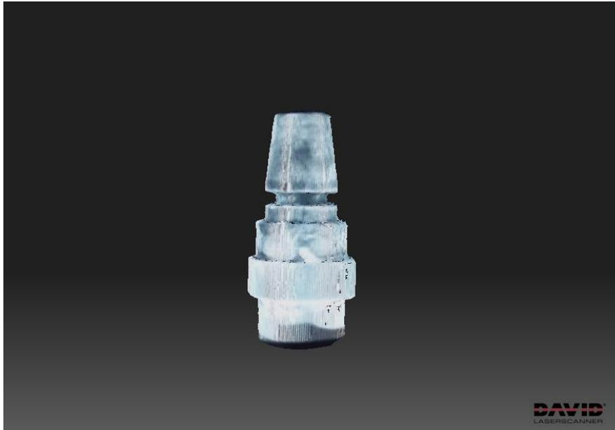
Figura 5. 12 Escaneo con textura de la pieza horneada y con polvos de talco.
