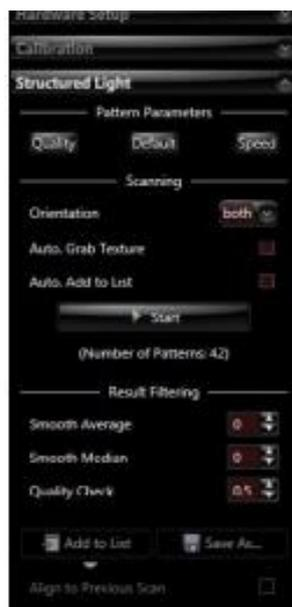
Figura 3. 22 Configuración de la luz estructurada.
