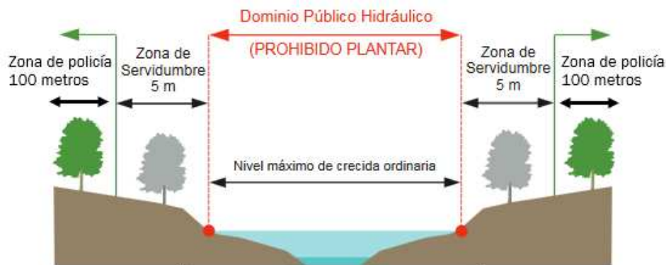
Figura 23. Esquema de las distancias legales de un cauce con sus distancias. Fuente: (Guía de distancias legales de plantaciones en Asturias).
