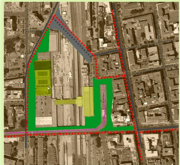
Fig.91 Rehabilitación Piazza Matteo Maria Boiardo en verde espacios peatonalizados, en rojo autobús, en fucsia la línea del tranvía, gris espacio para vehículos, en tono amarillo la estación de Nortarbartolo y de frente se encuentra el equipamiento deportivo.
