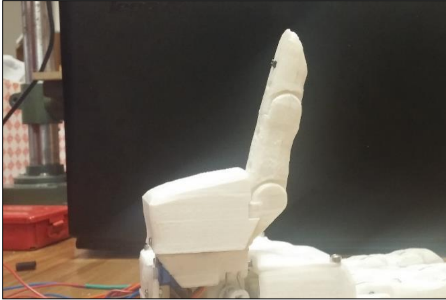
Imagen 39. Pulgar con el tendón montado y tensado.
