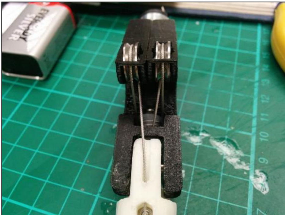
Imagen 33. Posición que debe tener el cable sobre los rodamientos.
