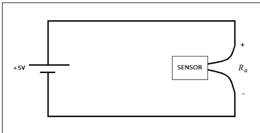
Imagen 56. Montaje empleado para medir la respuesta del sensor de presión.
