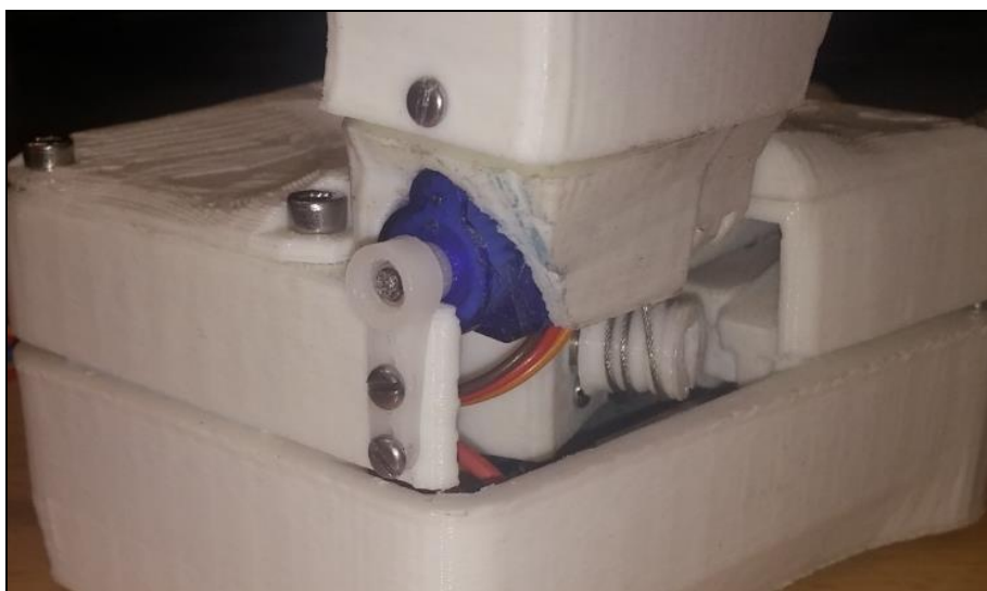
Imagen 37. Servo con su brazo ya instalado.
