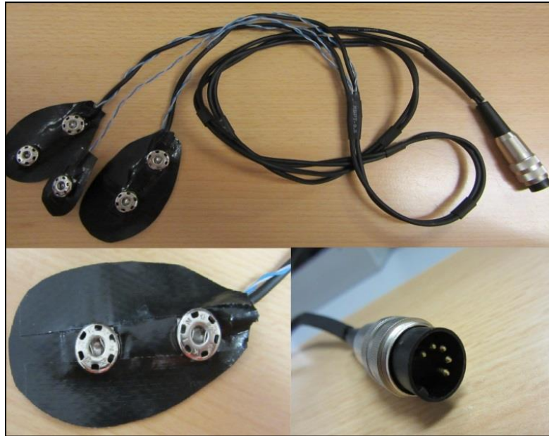
Imagen 77. Conector de los electrodos superficiales al sistema.
