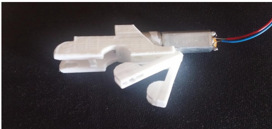
Imagen 31. Carcasa unida al motor y a los tensores.
