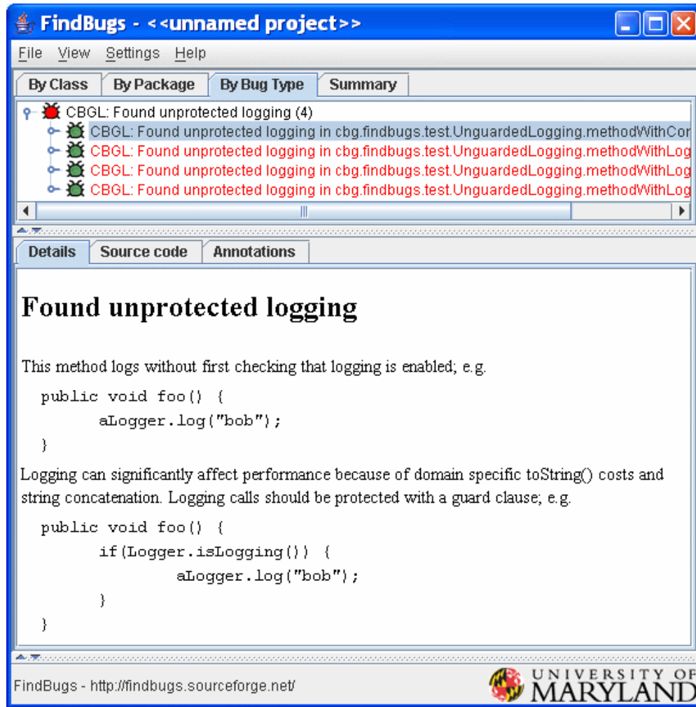
Ilustración 2. Ejemplo de Findbugs, mostrando la descripción del bug hallado
