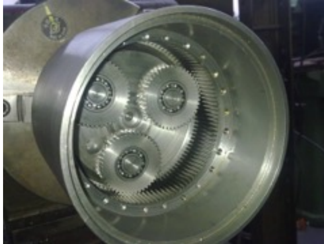
Figura 6: Sistema multiplicador por planetarios del dispositivo undimotriz, Argentina.
