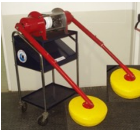
Figura 4: Prototipo undimotriz, escala 1:10, Argentina.
