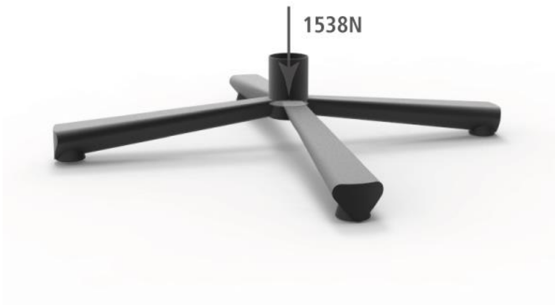
Fig.113-Carga aplicada sobre la superficie de apoyo del pistón de gas
