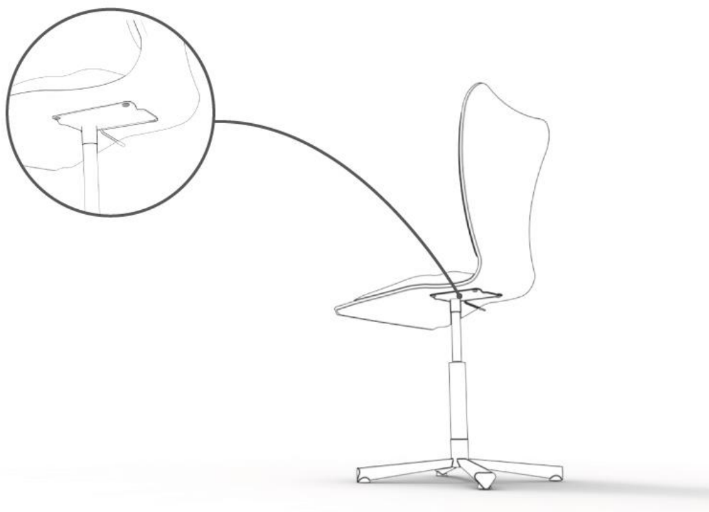
Fig.75-Detalle de la colocación de los remaches
