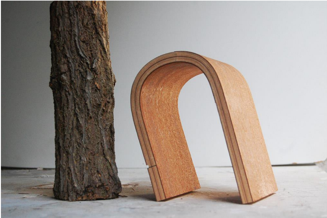
Fig.82- Gran curvatura lograda en un tablero laminado de gran espesor
