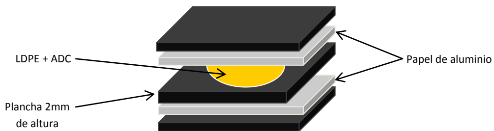
Figura 13 Representación esquemática del molde introducido en la prensa para el termoconformado.
