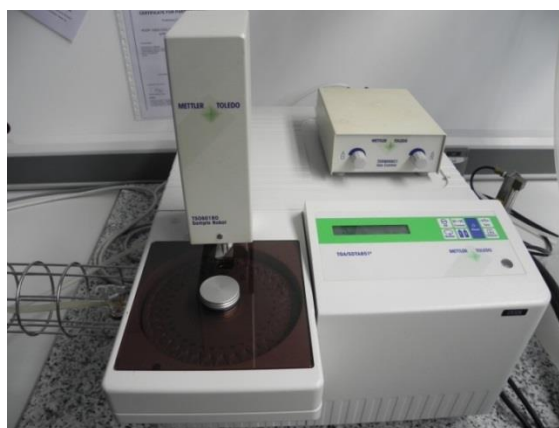
Figura 20 Balanza termogravimétrica utilizada en este trabajo.
