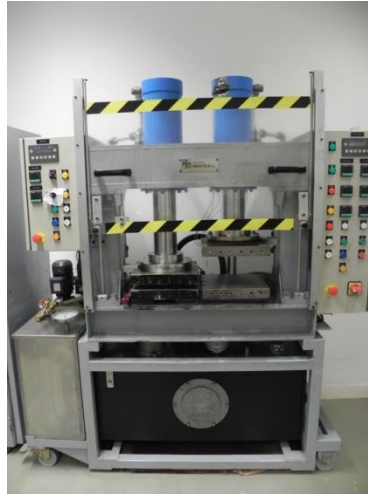
Figura 12 Prensa para termoconformado. Se observa el plato frío (izquierda) y el plato caliente (derecha).
