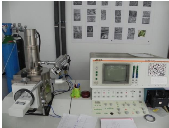
Figura 21 Fotografía del microscopio electrónico de barrido utilizado en este trabajo.
