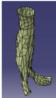
Figura 4.8 Superficie creada con el comando Automatic Surface.
