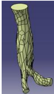
Figura 4.9 Superficie cosida con el comando Join.
